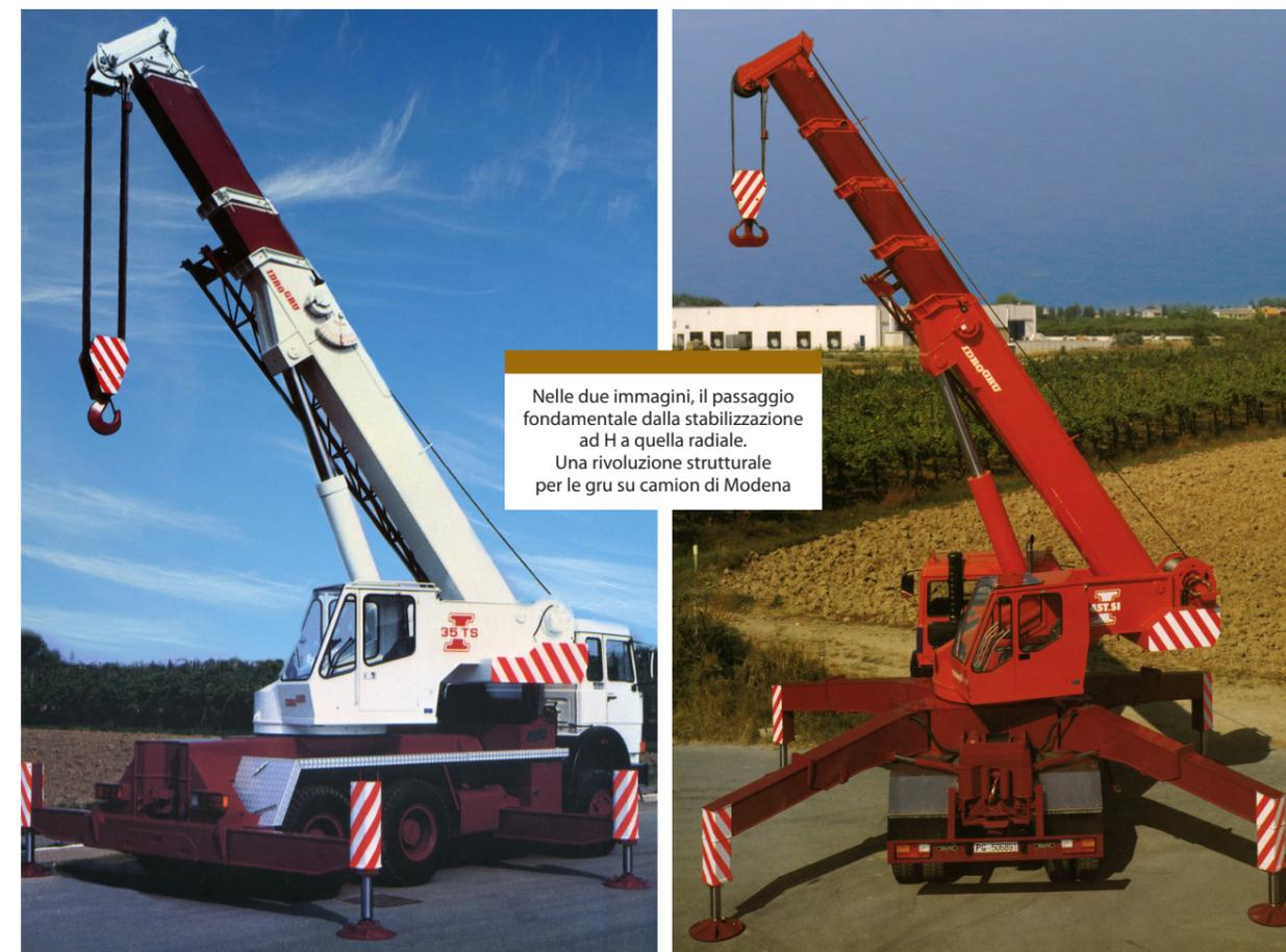
Nelle due immagini, il passaggio fondamentale dalla stabilizzazione ad H a quella radiale. Una rivoluzione strutturale per le gru su camion di Modena
